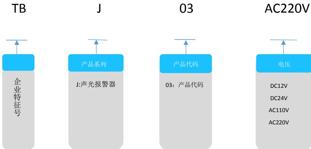
例如：TBJ-03 AC220V,代表声光报警器 03 款，额定工作电压为 AC220V，安装方式为螺丝安装，
